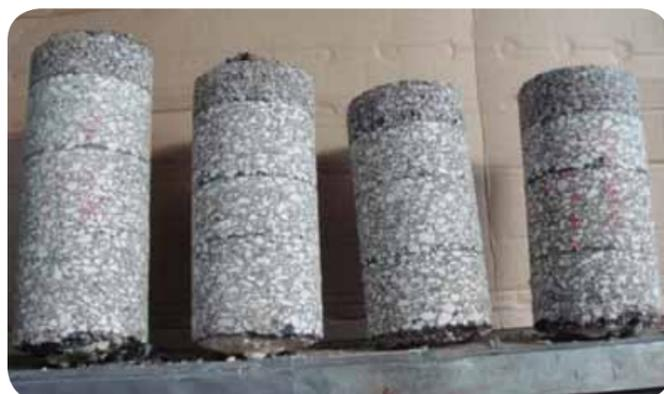
hervorragende Homogenität des vom Beschicker transportierten Mischguts
